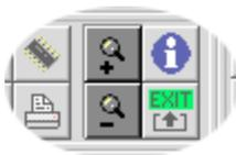
Cet affichage peut facilement être agrandi ou réduit avec les deux boutons zoom. Imagix essaie dans la mesure du possible de maintenir la position du localisateur. Avant d'utiliser le bouton zoom, positionnez le localisateur à l'endroit souhaité.
