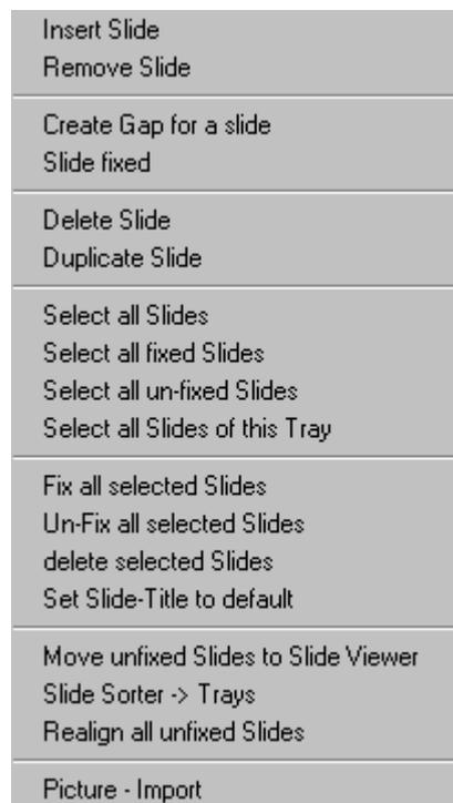
"Delete Slide" effacera la diapositive du chariot virtuel ainsi que le cas échéant de l'arrangeur. Le fichier IMC correspondant ne sera pas supprimé du disque dur. Contrairement à la fonction précédente "Remove slide", les autres diapositives ne seront pas avancées.
