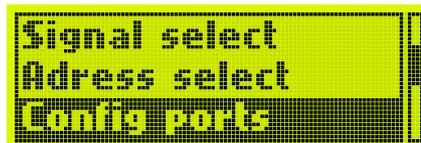
Nach „Enter“ und dreimaligem Betätigen der Taste nach unten erscheint die Auswahl zum Konfigurieren der Ports des APEX.
