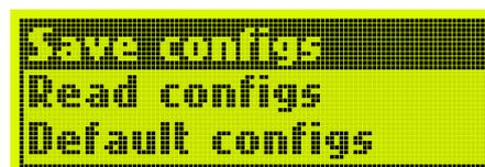
Mit „Save Configs“ werden die aktuellen Einstellungen in einen der Konfigurationsspeicher geschrieben. Damit sind sie bleibend abgespeichert, da sie beim nächsten Einschalten des Gerätes automatisch gelesen werden.
