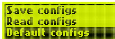
Diese Einstellung ersetzt nur die aktuelle Konfiguration. Soll diese in einen der Speicher geschrieben werden, muß das mit der Funktion „Save configs“ noch getan werden.
