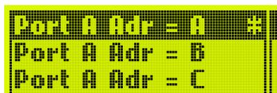
Hier kann jetzt eine der 16 möglichen Adressen ausgewählt werden. Nach „ESC“ und Auswählen eines neuen Port kann die nächste Adresse eingestellt werden. Beim Verlassen mittels mehrmaligen ESC bekommt man abschließend die vier Adressen nochmals angezeigt.
